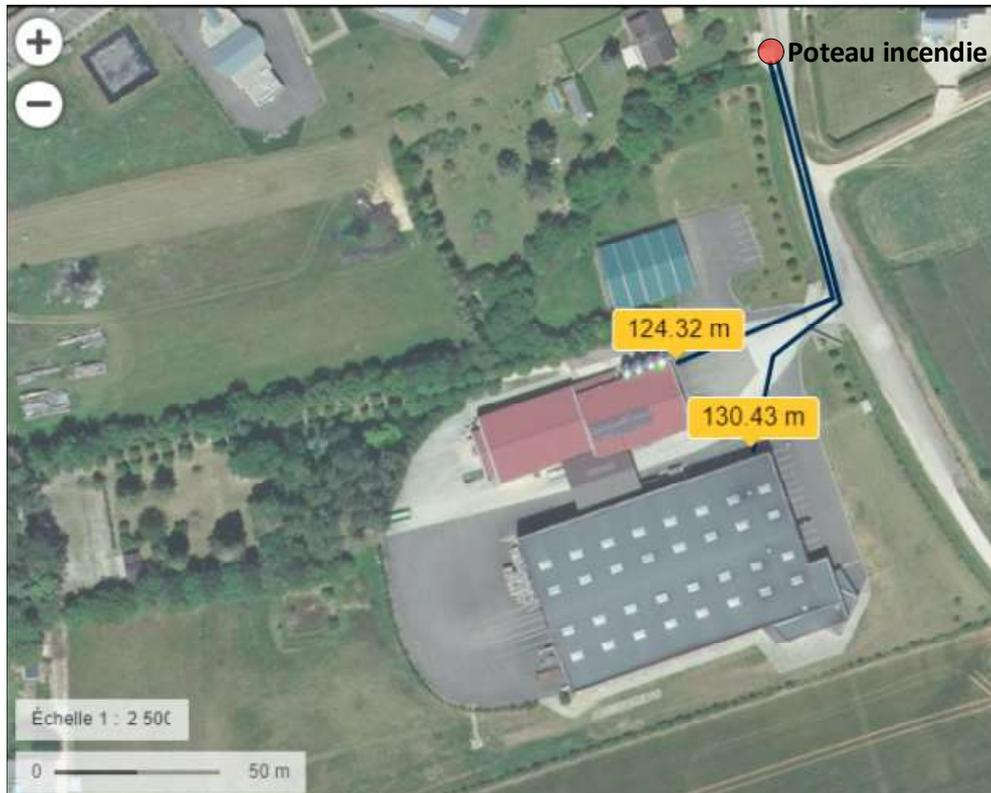
Ce poteau est conforme et délivre 115 m<sup>3</sup>/h sous 1 bar (voir PV de contrôle de 2020 en annexe 1).
